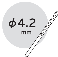
ドリルビット 吊元柱の丁番取付孔 穿孔用
