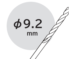
ドリルビット 吊元柱の丁番取付孔 穿孔用
